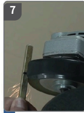
ตัดเหล็กแบนให้ยาวเกินความหนาประตูประมาณ 2 ซม.
